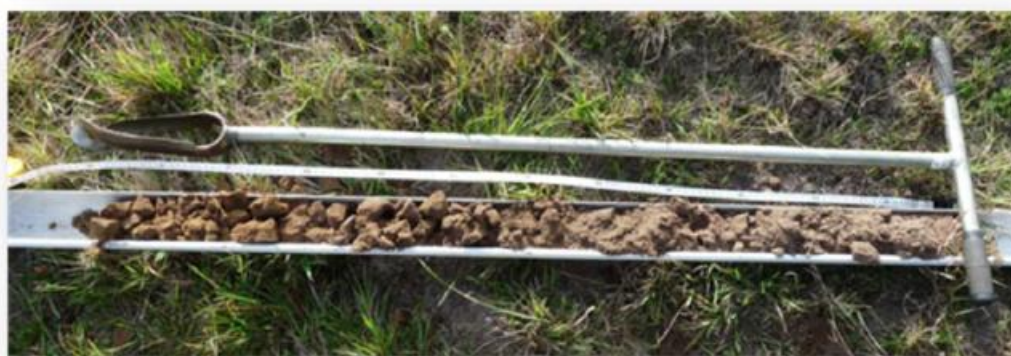
Figure 121 : Sondage pédologique à la tarière manuelle (Source : Ecosphère)
