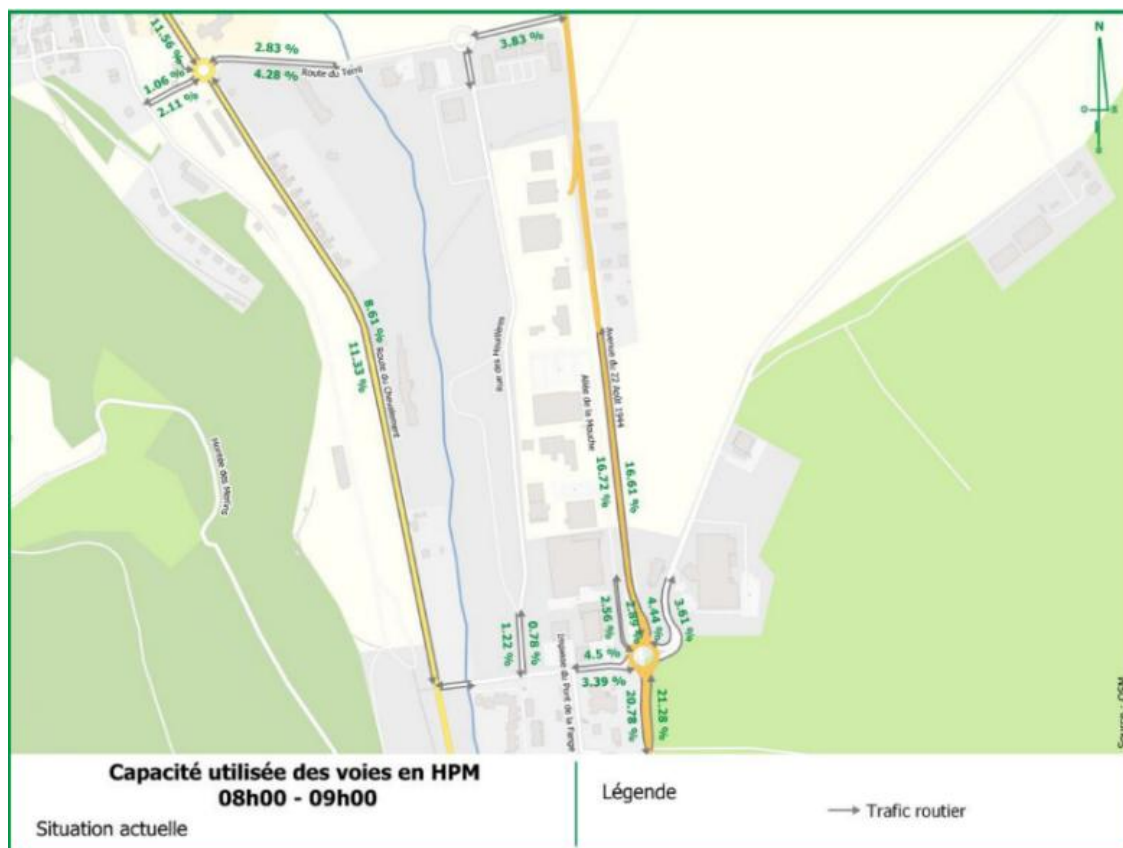
Figure 111 : Capacité utilisée des voies en heure de pointe du matin (Source : Etude diagnostic, Ceryx Traffic System, Février 2023)
